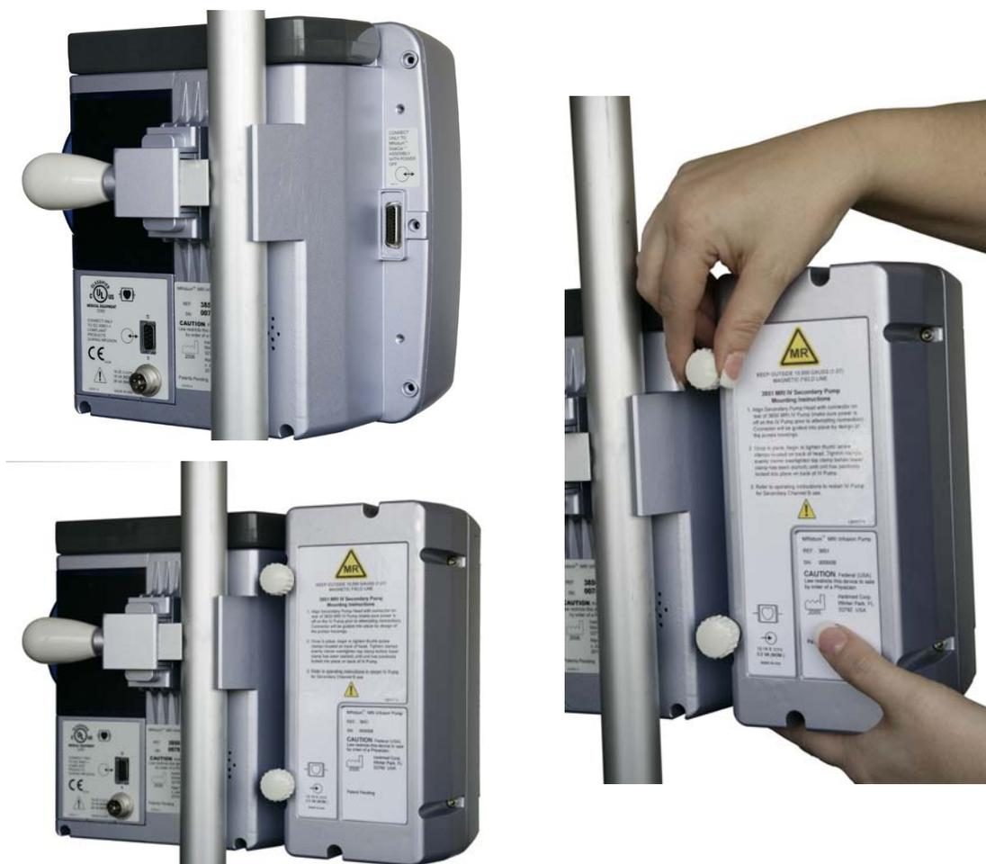
**Figura 4-5. Collegamento "SideCar" Canale B**
